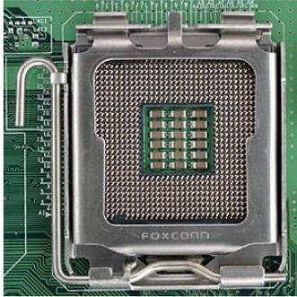
**Soquete 775** – usados por processadores pentium 4, nos modelos com 2.8, 3.0, 3.2 e 3.4GHz, operando 800 Mhz e usam a tecnologia Hyper-Threading.
