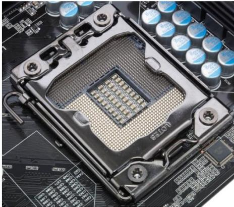
**Socket B** - ou popularmente conhecida como soquete **LGA 1366**, é mais um padrão de soquetes que fora desenvolvida pela Intel, e projetada para substituir o modelo de soquete LGA 775. Sendo direcionado como modelo padrão da Intel, a soquete LGA 1366 tem o seu uso direcionado a processadores Core i7.
