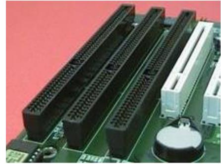
**Slot EISA – Extended Industry Standard Architecture:** é uma modificação do ISA. Esse slot já trabalha com barramentos de 32 bits, mas usa o padrão ISA, ou seja as placas ISA podem ser conectadas em Slots EISA.
