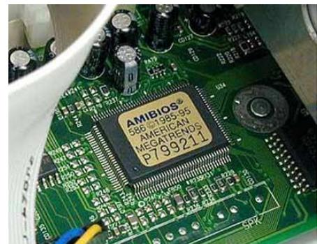
Já no PC esta memória contém informações referentes ao funcionamento do computador, nela está armazenado um programa chamado BIOS – Basic Input/Output System ou Sistema Básico de Entrada e Saída. É nessa memória que se encontra o programa SETUP, que faz a configuração da Placa-Mãe.
